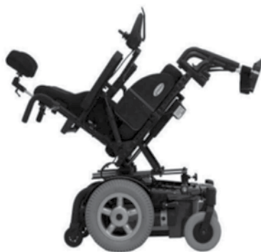
Figura 3. Ilustrações de cadeiras de rodas que permitem a mudança da distribuição da pressão decorrente da alteração na inclinação em relação ao plano horizontal ("tilt") com ajuste eletrônico. (Figura gentilmente pela Freedom, 2013).
